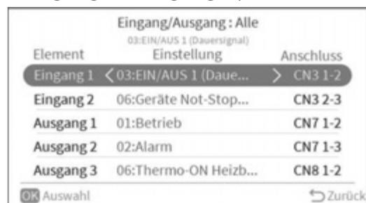
„**Alle**“ Inneneinheiten aus, da sonst einige Einstellungen nicht wählbar sind. Nun sehen Sie eine Übersicht mit allen Ein- und Ausgängen und gewählten Einstellungen. Wählen Sie einen Parameter aus, und Sie sehen sofort die Funktion und Einstellung. Wenn Sie den Parameter verstellen (rechts/links) werden sofort die neuen Werte angezeigt. **Achtung:** Belassen Sie die Parameter normal in dieser Einstellung. Mehr Details finden Sie in der Gesamtübersicht.
