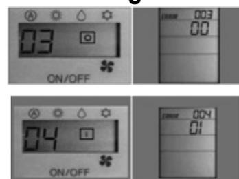
\* Bei den neuen Inneneinheiten der airHome Serie wird zusätzlich auch der Fehlercode der Außeneinheit dargestellt. In diesem Fall blinkt alternativ die Betriebs LED (Intervalle zählen)
