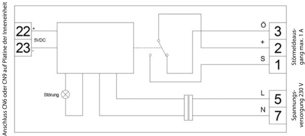
Leitungsenden des beiliegenden Steckers an Klemme 22 (gelb) und 23 (braun) auf der Zusatzplatine anschließen. Einen der vorhandenen Stecker auf CN6 oder CN9 der Inneneinheit stecken (je nach Inneneinheit).
