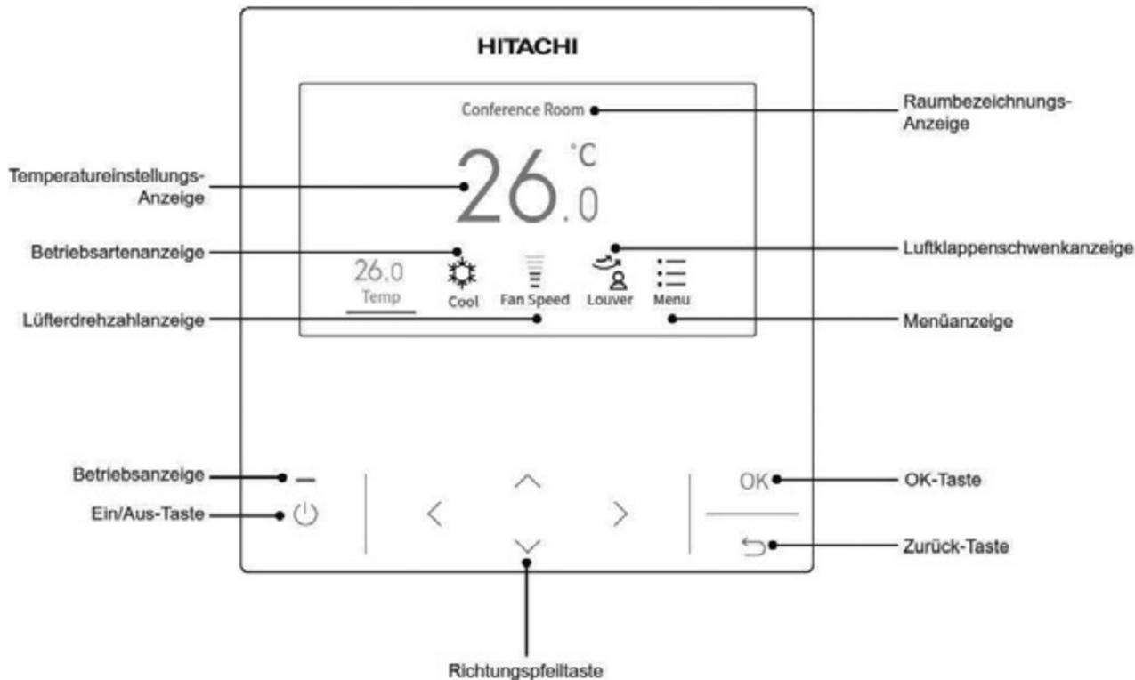
**Starten** Sie die Anlage über die **EIN/AUS-Taste**. Die Anlage ist eingeschaltet, wenn die **grüne LED** leuchtet bzw. das Louver-Symbol abgezeigt wird. Zum **Abschalten** drücken Sie einfach erneut die **EIN/AUS-Taste**. Die grüne LED erlischt.
