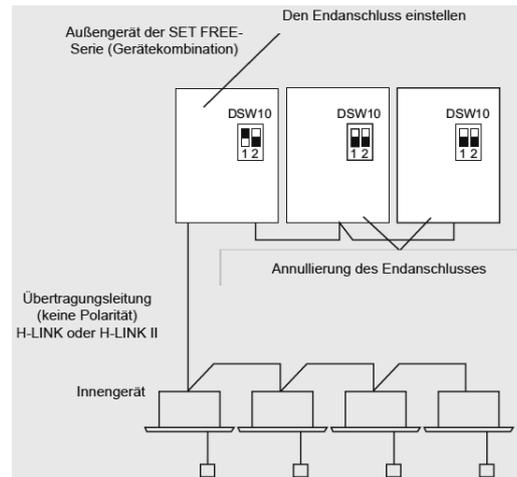
Beträgt die Anzahl der Kühlkreisläufe im selben H-LINK oder H-LINK II, stellen Sie alle Pins Nr. 1 von DSW10 auf die Position „OFF“, außer das Hauptaußengerät A.
