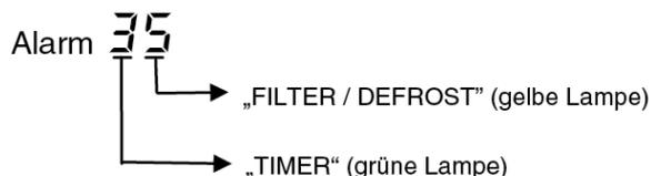
Die Alarmmeldung selbst bzw. der normale Filteralarm wird über die **RESET** Taste zurückgesetzt.
