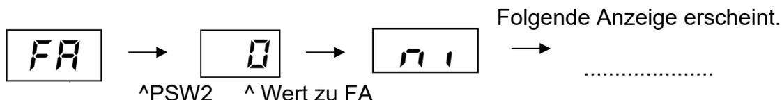
Durch wiederholtes drücken der Taste **PSW2** wechselt die Anzeige zu der jeweiligen Funktion. Die Zahl die als nächstes erscheint ist der dazugehörige Wert. Durch drücken der Taste **PSW1** wechselt der Wert der Funktion. 1= aktiv 0= nicht aktiv. (**Werkseinstell. = 0**)
