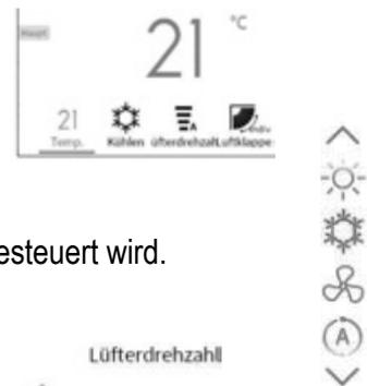
Wählen Sie den gewünschten **Modus** aus. Es ist möglich, dass der Modus zentral gesteuert wird. Sie können zwischen **Kühlen / Heizen / Lüften / Trocknen** und **Automatik** wählen.
