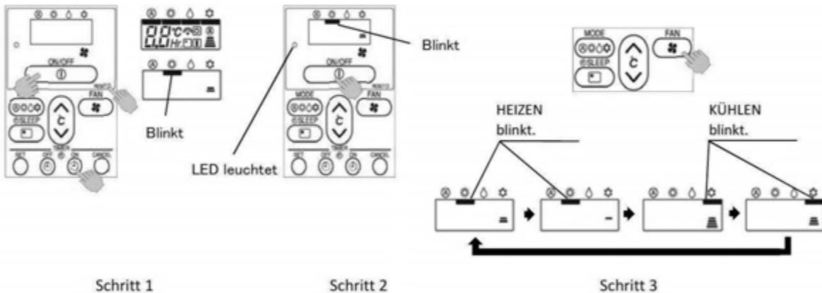
4. Drücke die **[TEMP V or A]** Tasten um die Verschiebung einzustellen (Verschiebung in K).
