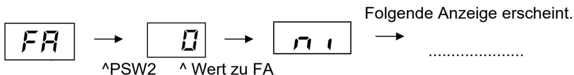
Durch wiederholtes drücken der Taste **PSW2** wechselt die Anzeige zu der jeweiligen Funktion. Die Zahl die als nächstes erscheint ist der dazugehörige Wert. Durch drücken der Taste **PSW1** wechselt der Wert der Funktion. 1= aktiv 0= nicht aktiv. (**Werkseinstell. = 0**) Zum Speichern der Parameter brauchen nur die beiden DIP-Schalter zurückgesetzt werden. Stellen Sie dazu Pin 5 von DSW2 auf Off. Danach Pin 4 von DSW1 auf Off.
