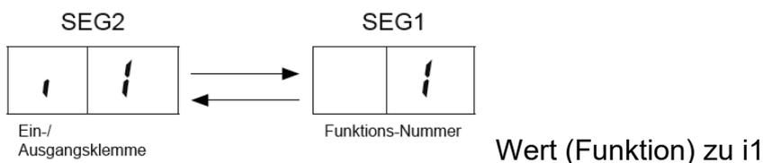
Durch wiederholtes drücken der Taste PSW2 wechselt die Anzeige zu der jeweiligen Funktion. Die Zahl die daneben steht, ist der dazugehörige Wert. Durch Drücken der Taste PSW1 wechselt der eingestellte Wert der Funktion.
