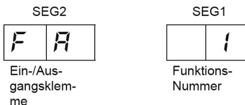
Durch Drücken der Tasten PSW2 und PSW3 wechselt die Anzeige zur jeweiligen Funktion. Die Taste PSW1 wechselt die Einstellung 1= aktiv 0= nicht aktiv. (Werkseinstellung 0) Zum Speichern der Parameter brauchen nur die beiden DIP-Schalter zurückgesetzt werden. Stellen Sie dazu **Pin 5** von **DSW2** auf **Off**. Danach **Pin 4** von **DSW1** auf **Off**.
