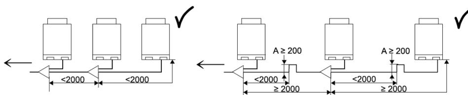
Sind die Kältemittelleitungen (Gas und Flüssigkeit) zwischen Außengeräten länger als zwei Meter, muss die Ölauffangvorrichtung in der Gasleitung installiert werden, um eine Ansammlung von Kältemaschinenöl zu vermeiden.
