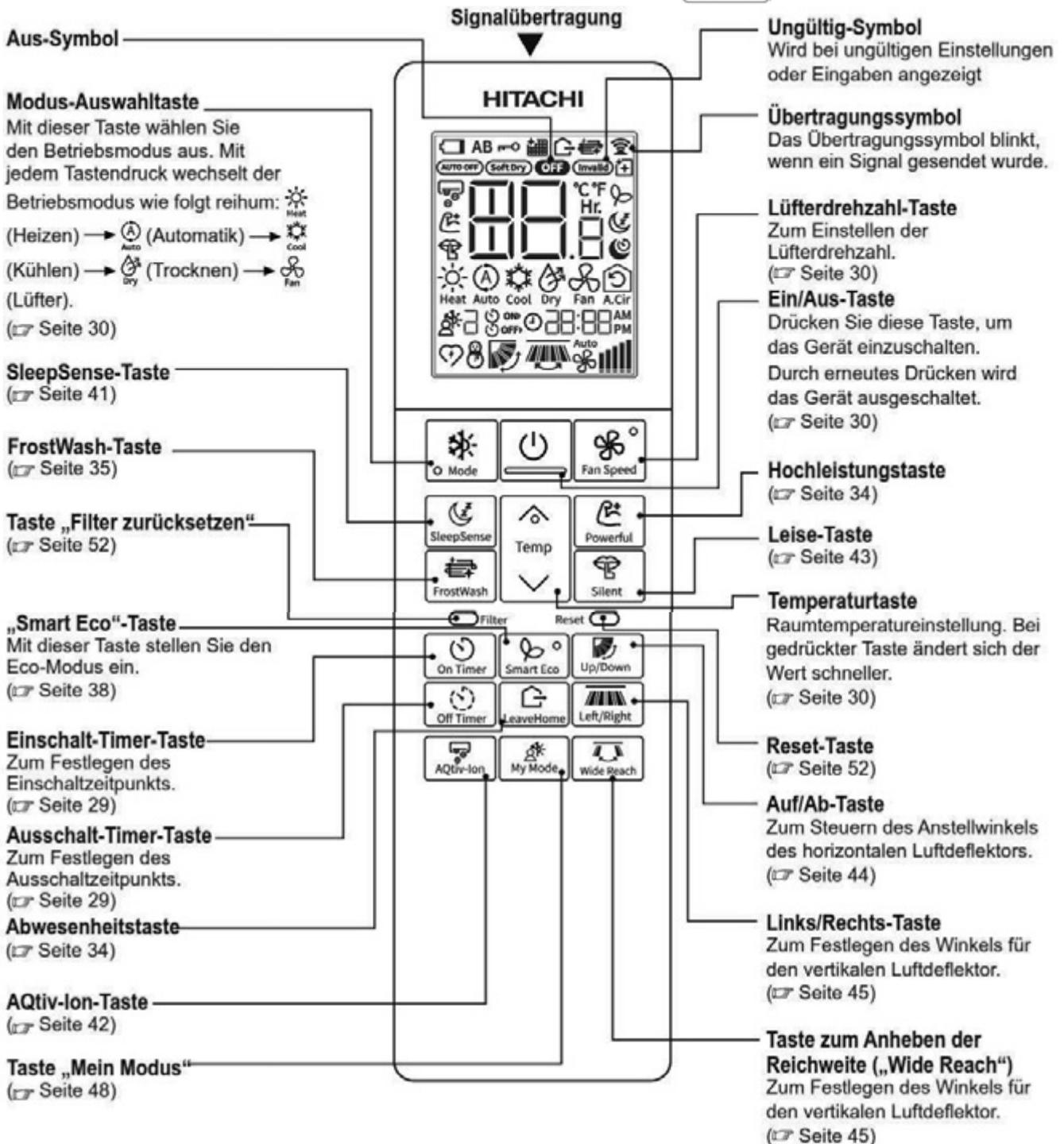
\* Die Tasten „AQtiv-Ion“, „Links/Rechts-Taste“ und „Wide Reach“ sind nur bei airHome 600 verfügbar.
