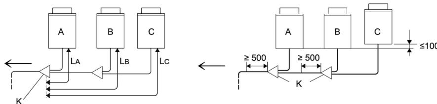
Die Länge zwischen dem Anschluss-Kit -K- (auf der Seite des Außengeräts) und dem Außengerät muss sein:  $L_A \leq L_B \leq L_C \leq 10$  m.
