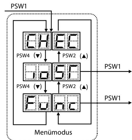
Durch Drücken der Taste PSW2 oder PSW4 wechselt die Anzeige zu dem nächsten Ein- bzw. Ausgang. Die Zahl die als nächstes erscheint ist der dazugehörige Wert der Funktion. Durch Drücken der Taste PSW3 oder PSW5 wechselt der eingestellte Wert der Funktion. Zum Beenden drücken Sie erneut die PSW1 Taste, Sie gelangen wieder in die erste Menüebene. Drücken Sie die Taste PSW1 erneut für drei Sekunden. Die Anzeige wechselt in die normale Anzeige. Stellen Sie Pin 4 von DSW 4 auf Off.
