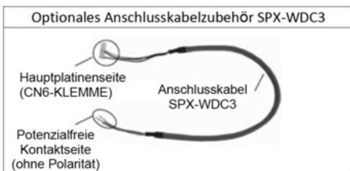
Zum Nutzen des Sperrsignals (z. B. als Fensterkontakt oder zur Netz-Dienlichkeit) muss die Anlage zunächst eingeschaltet sein. Das Schließen der 2 Kontakte führt den Sperrbefehl aus (oder entsperrt falls ausgewählt). Nach öffnen geht die Anlage wieder in Betrieb, wenn sie zuvor eingeschaltet war.
