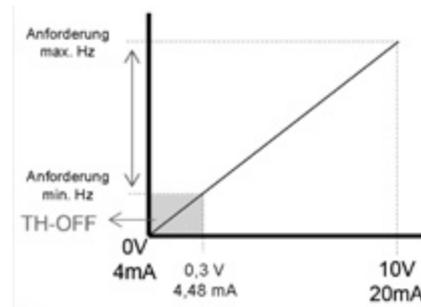
Bei Utopia wird die Verdichter Drehzahl nur innerhalb des möglichen Regelbereiches des Verdichters angepasst (sollte die kleinste mögliche Verdichter Drehzahl erreicht sein, wird diese gehalten). Die bestmögliche Regelung wird mit den Sondermodellen Utopia RAS-**X**H(V)NP(1)E (nur Single 100%) erzielt.
