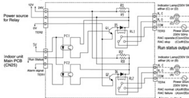
Optionale (Bauseitige) Spannungsversorgung DC 12V oder 24V
