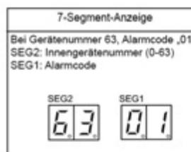
Sollte die Außeneinheit laufen und gleichzeitig **P.....** anzeigen ist das keine Fehlermeldung sondern ein **Regelvorgang**. Ein kurzer Regelvorgang ist normal, sollten diese P... Meldungen gar nicht weggehen, hat das System ein Regelproblem was nicht behoben werden kann. (z.B. Füllmenge nicht normal, E-Ventile defekt, Leitungen verstopft, defekte Platinen / Bauteile oder andere Probleme)
