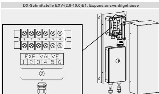
Verbindungsleitung zum E-Ventil 6 Adern 6x 0,5mm<sup>2</sup>
