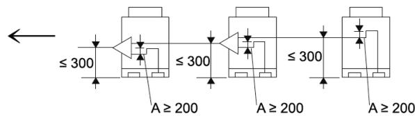
Wenn der Anschluss-Kit auf einer höheren Ebene als der Anschluss der Kältemittelrohrleitungen des Außengeräts positioniert wird, einen Höchstabstand von 300 mm zwischen Anschluss-Kit und Boden des Außengeräts einhalten. Außerdem muss zwischen Anschluss-Kit und Außengerät ein Ölvorwärmer -A- (mindestens 200 mm) installiert werden.
