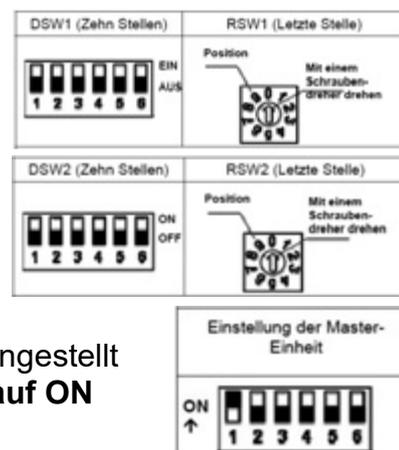
Sollten **ein oder mehrere** Inneneinheiten auf einem Kältekreislauf eingestellt sein, **muss ein Gerät** als Master konfiguriert werden. **DSW3 Pin 1 auf ON** (Rest OFF).
