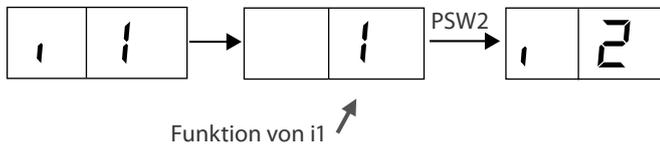
Durch wiederholtes Drücken der Taste PSW2 wechselt die Anzeige zu dem nächsten Ein- bzw. Ausgang. Die Zahl die als nächstes erscheint ist der dazugehörige Wert der Funktion. Durch drücken der Taste PSW1 wechselt der eingestellte Wert der Funktion. Zum Speichern der Parameter brauchen nur die beiden DIP-Schalter zurückgesetzt werden:
