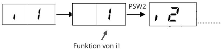
Durch wiederholtes drücken der Taste PSW2 wechselt die Anzeige zu dem nächsten Ein- bzw Ausgang.
