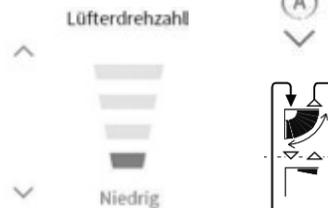
Wählen Sie die **Louver** position (**Luftklappe**) aus. In der Anzeige sieht man den entsprechenden Winkel des Luftaustrittsflügels. Falls alle Positionen angezeigt werden, ist ein Swing-Betrieb gewählt. Wählen Sie eine Einstellung, um Zugerscheinungen möglichst gering zu halten.
