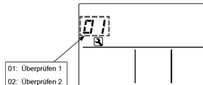
Über die Temperaturtasten können Sie zu den verschiedenen Parametern wechseln.
