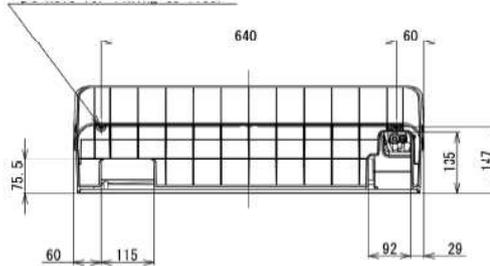
Rückseitige Befestigungsbohrung der Größe  $\varnothing 9$  für Verankerungsschrauben
