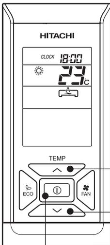
**2** Stellen Sie die gewünschte LÜFTERDREHZAHL über die Taste FAN (LÜFTERDREHZAHL) ein (die Einstellung wird auf dem Display angezeigt).
