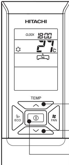
**2** Stellen Sie die gewünschte Ventilatorzahl mit der Taste (VENTILATOR-DREHZAHL) ein (die Einstellung wird angezeigt).
