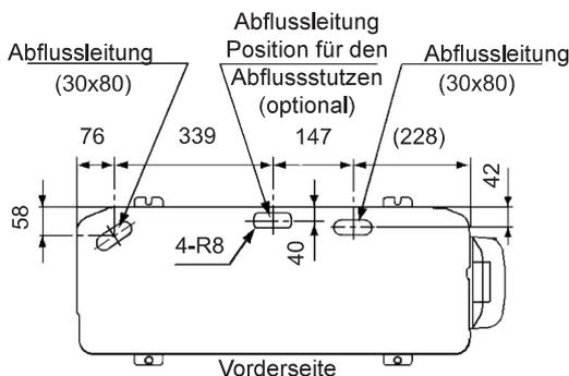
5 Der gesamte Fuß des Außengeräts sollte bei der Installation auf dem Untergrund stehen. Bei der Verwendung einer Vibrationsdämpfermatte sollte das Gerät genauso platziert werden. Wenn Sie das Außengerät auf einem Rahmen (nicht mitgeliefert) installieren, verwenden Sie entsprechend breite Metallplatten, um, wie in der Abbildung gezeigt, eine ausreichende Auflagestabilität zu erzielen.
