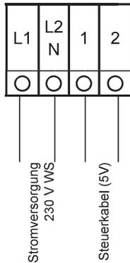
Anweisungen für die Verkabelung an der Klemmleiste:
