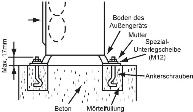
Befestigen Sie das Außengerät unter Verwendung von speziellen, werkseitig mitgelieferten Unterlegscheiben mit den Ankerschrauben.
