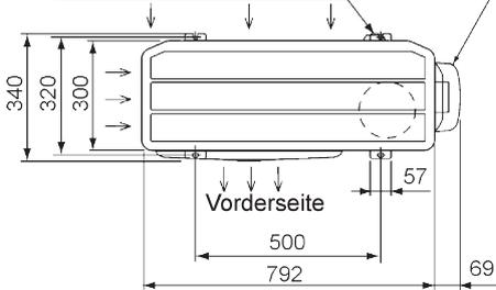
3 Beispiele zur Befestigung des Außengeräts mit Ankerschrauben.
