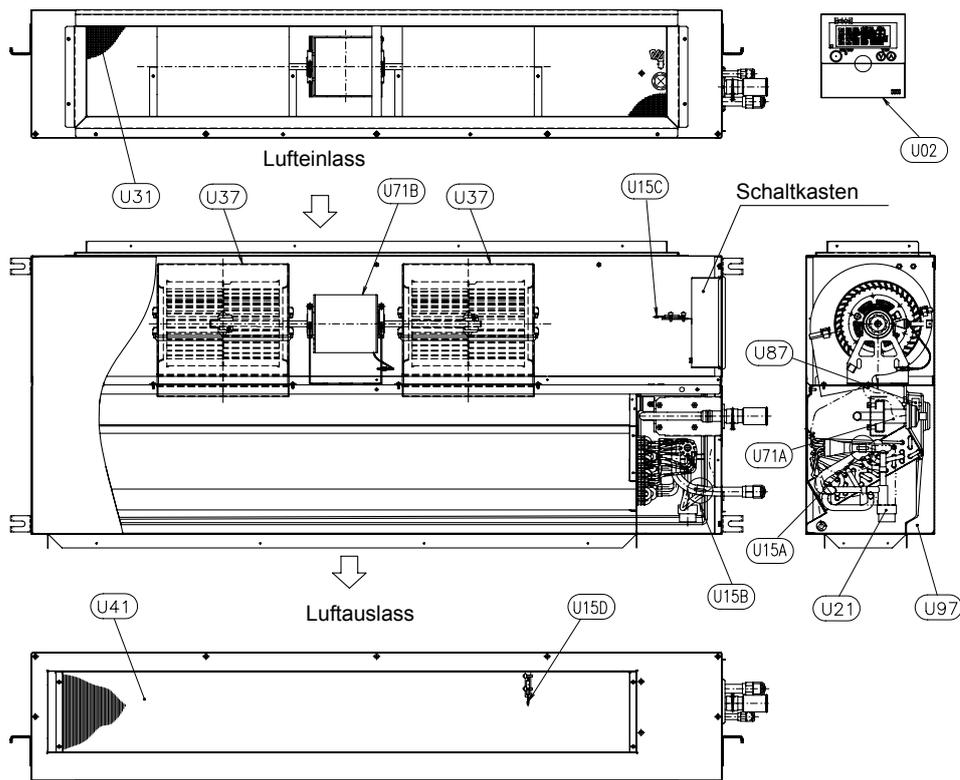
Position der elektrischen Bauteile
