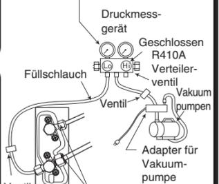
**2** Drehen Sie das Ventil mit der Kennzeichnung „Hi“ des Verteilerventils ganz zu und öffnen Sie das Ventil mit der Kennzeichnung „Lo“ vollständig. Lassen Sie die Vakuumpumpe etwa 10 bis 15 Minuten lang laufen. Drehen Sie anschließend das Ventil mit der Kennzeichnung „Lo“ ganz zu und schalten Sie die Vakuumpumpe aus.
