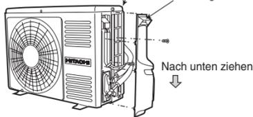
Entfernen Sie die Seitenabdeckung, wenn Sie die Rohrleitungen und das Verbindungskabel anschließen.
