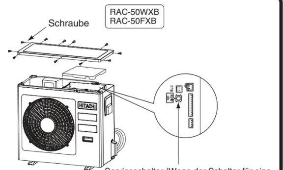
Serviceschalter (Wenn der Schalter für eine Sekunde oder länger gedrückt wird, führt das Gerät eine erzwungene Kühlung durch. Wenn der Schalter erneut für eine Sekunde oder länger gedrückt wird, beendet das Gerät die erzwungene Kühlung.)
