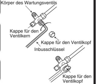
**3** Drehen Sie die Spindel des Wartungsventils (an 2 Stellen) entgegen dem Uhrzeigersinn vollständig auf, damit das Kühlmittel fließen kann (verwenden Sie dazu einen Inbusschlüssel).
