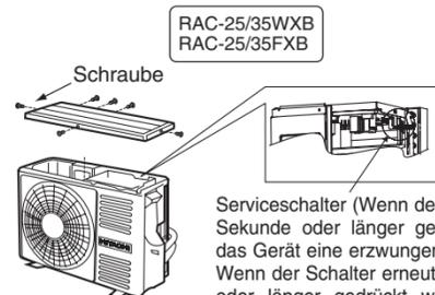
Serviceschalter (Wenn der Schalter für eine Sekunde oder länger gedrückt wird, führt das Gerät eine erzwungene Kühlung durch. Wenn der Schalter erneut für eine Sekunde oder länger gedrückt wird, beendet das Gerät die erzwungene Kühlung.)
