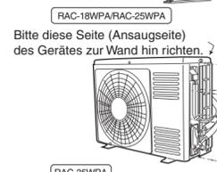
Beim Anschließen der Rohrleitung und des Verbindungskabels bitte die seitliche Abdeckung abnehmen.
