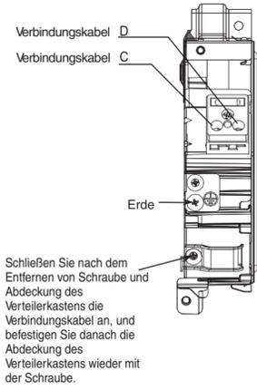
Schließen Sie nach dem Entfernen von Schraube und Abdeckung des Verteilerkastens die Verbindungskabel an, und befestigen Sie danach die Abdeckung des Verteilerkastens wieder mit der Schraube.
