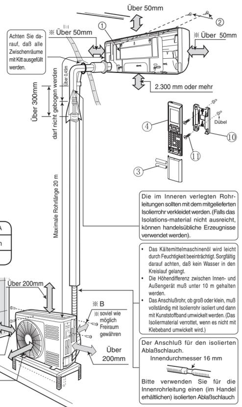
Die im Inneren verlegten Rohrleitungen sollten mit dem mitgelieferten Isolierrohr verkleidet werden. (Falls das Isolationsmaterial nicht ausreicht, können handelsübliche Erzeugnisse verwendet werden.)
