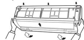
**WIE WIRD DAS INNENGERÄT ABGEBAUT**
