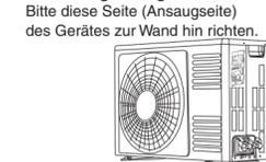
Beim Anschließen der Rohrleitung und des Verbindungskabels bitte die seitliche Abdeckung abnehmen.
