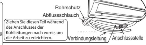
Ziehen Sie diesen Teil während des Anschlusses der Kühllleitungen nach vorne, um die Arbeit zu erleichtern.
