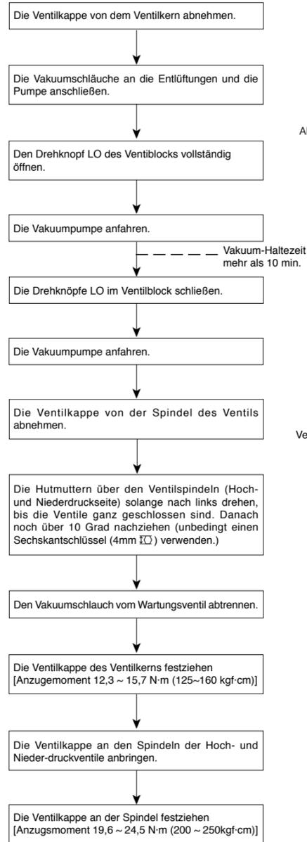
**Entlüftung mit Vakuumpumpe**
