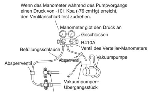
Wenn das Manometer während des Pumpvorgangs einen Druck von -101 Kpa (-76 cmHg) erreicht, den Ventilanschluß fest zudrehen.
