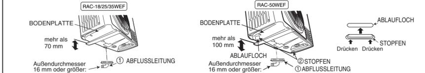
• Installieren Sie das Außengerät horizontal und stellen Sie sicher, dass das Kondenswasser abläuft.
