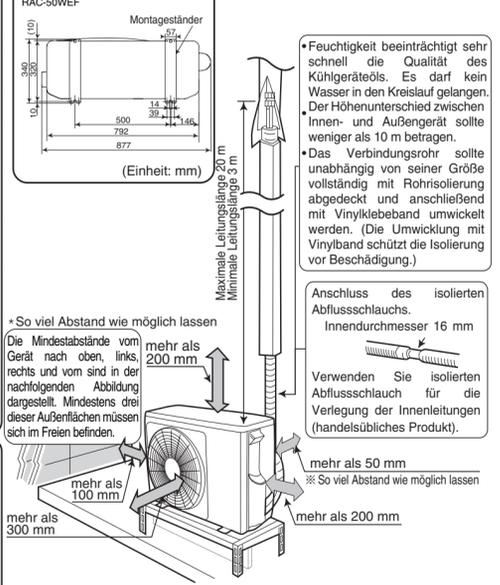
Bei der Installation des Außengeräts muss an mindestens zwei Seiten des Geräts ausreichend Raum für die gute Luftzirkulation bleiben.
