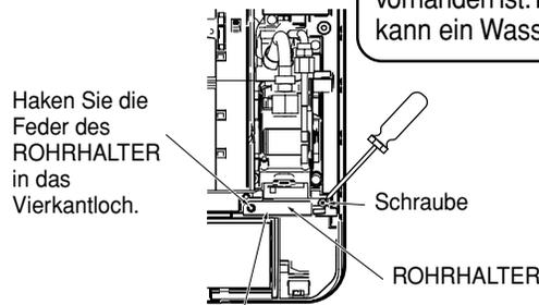
Montieren Sie den ROHRHALTER, so dass der Zylinderteil des Auslassgefäßes durch sein Loch durchgeht; befestigen Sie den Halter mit den an der rechten Rückecke befindlichen Schrauben.
