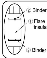
Wickeln Sie den Flare Insulation und binden den Ober- und Unterisolator mit Binder. Wickeln Sie eng das Band auf dem Flare Insulation.
