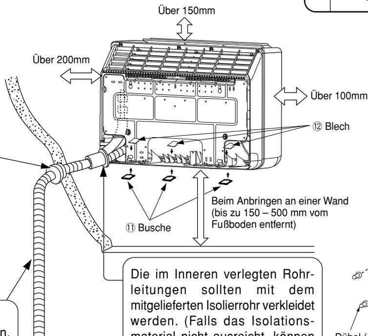
Die im Inneren verlegten Rohrleitungen sollten mit dem mitgelieferten Isolierrohr verkleidet werden. (Falls das Isolationsmaterial nicht ausreicht, können handelsübliche Erzeugnisse verwendet werden).
