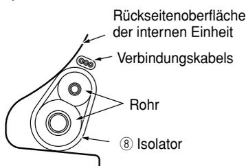
Rohr- /Abflussschlauch Layout beim Durchgang durch das Loch auf der Wand
