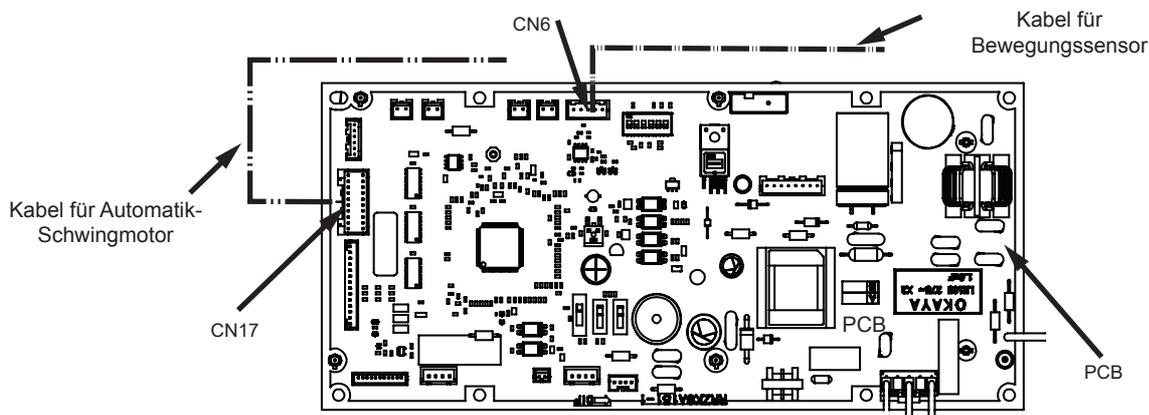
Folgende Anschlüsse werden für die Luftaustrittsblende benutzt. Entfernen Sie das Band, das die Kabelanschlüsse an der Luftaustrittsblende befestigt, und ziehen Sie sie heraus. Schließen Sie diese mit den Steckern an CN17 und CN6 im Schaltkasten wie abgebildet an.
