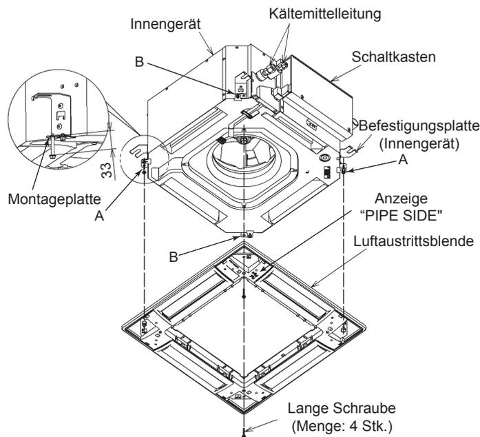
9 Ziehen Sie die langen Schrauben an, bis der Anschlag die Befestigungsplatte berührt.
