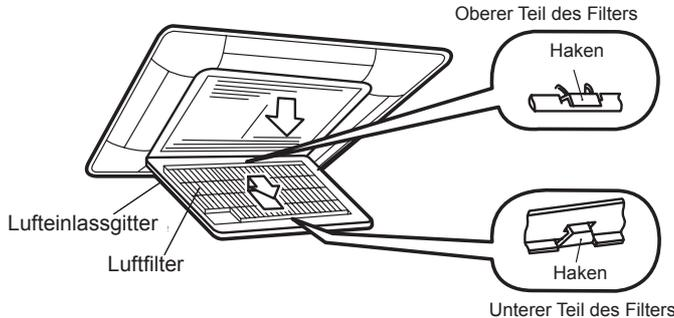
**3 Reinigen Sie den Luftfilter.**
