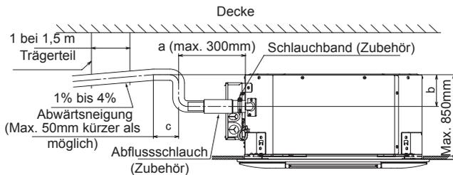
8 Bringen Sie die mitgelieferte Schlauchklemme am Vinylstreifen (grau) des Abflussschlauchs an. Die Schlauchklemme muss sich mindestens 20 mm von der Endseite des Abflussschlauchs befinden. Ziehen Sie dann die Schlauchklemme an und vergewissern Sie sich, dass wie gezeigt zwischen ihrem Rand und der Schraube 28 mm Abstand sind:
