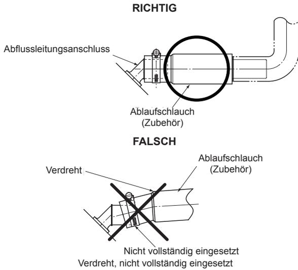
7 Beim Anheben der Abflussleitung installieren Sie diese gemäß den abgebildeten Maßen. Die gesamte Abflussrohrlänge von a+b+c darf nicht länger als 1100mm sein.
