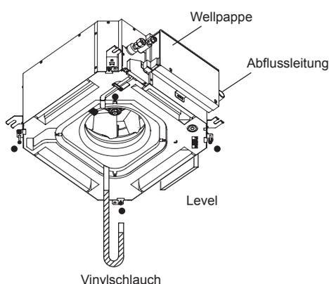
Prüfen Sie die Ebenheit an jeder Ecke (•) des Geräts mit einer Wasserwaage oder füllen Sie den Vinylschlauch wie abgebildet mit Wasser. Die Ecke an der Seite der Abflussleitung sollte 1 bis 3mm tiefer liegen.
