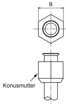
Prüfen Sie, dass keine Kratzer, festgesetzter Schleifstaub, Deformation oder Oberflächenunebenheiten am Konussteil vorhanden sind.
