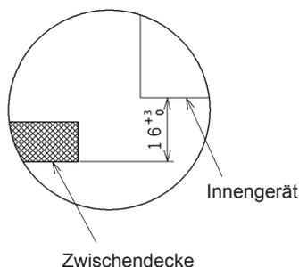
6 Befestigen Sie die Schraube "A" am Befestigungsgestell des Geräts und bewahren Sie dabei etwa 33mm des Schraubengewindes.
