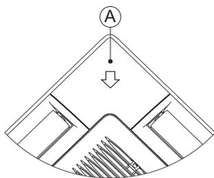
5 Kontrollieren Sie, dass der Abstand zwischen der Unterseite des Innengeräts und der abgehängten Decke wie gezeigt  $16^{+3}_0$  mm beträgt.
