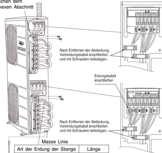
Erdenstange (wahlweise freigestellt) (Masse Leitung und Erdung Stange werden nicht geliefert. Benutzen Sie bitte wahlweise freigestellte Einzelteile unten)
